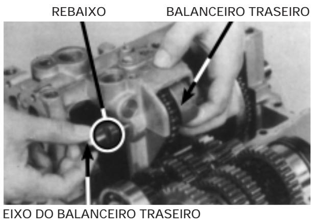
Levante ligeiramente o suporte do balanceiro e instale a guia da corrente do balanceiro.
