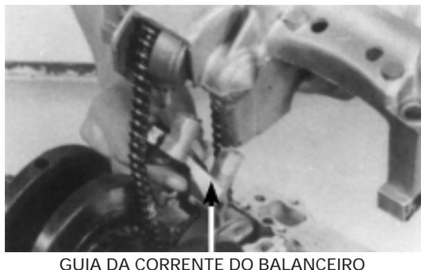
Instale o suporte da árvore de manivelas na carcaça do motor. Certifique-se que a marca "TC" do balanceiro dianteiro, a marca de referência da árvore de manivelas e a marca "TH" do balanceiro traseiro estejam alinhadas com a superfície de união das carcaças do motor.
