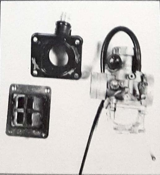
Carburador (que, na DT, dá margem a muitos ajustes diferentes o que é bom), e válvula de páleto. Esta peça estava com as medidas acima do limite, o que não pode acontecer, sob pena de perda de rendimento.
